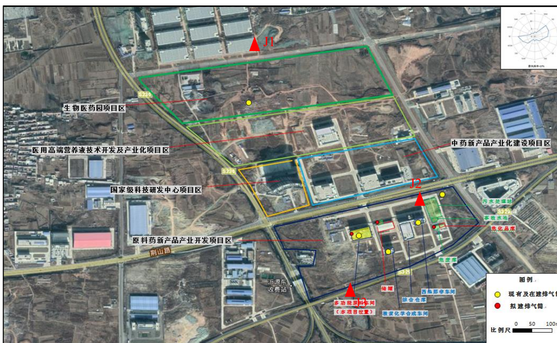
图 7.3.6-1 地下水水质跟踪监测井位置示意图
