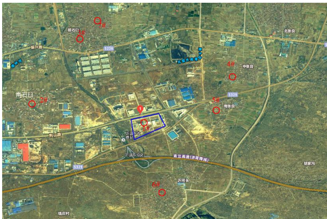
图 6.3.1-1 地下水监测布点图
